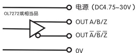
推拉输出型输出回路
